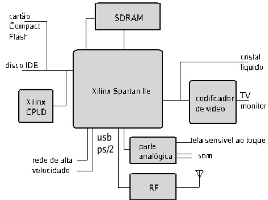
A figura acima é um diagrama de blocos da placa usada nos computadores Plurion C02 e Plurion Au02. As interfaces com o cristal líquido e com a tela sensível ao toque só são usadas neste último modelo.
